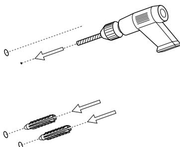
Bohren Sie das markierte Loch und setzen Sie den Dübel in das Loch ein.
