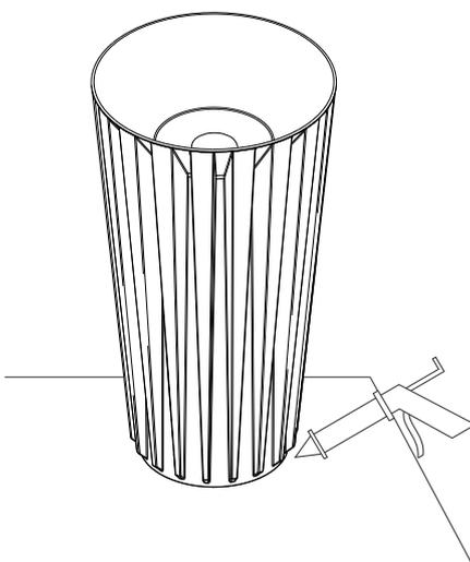
**B. Befestigen Sie das Waschbecken mit dem mitgelieferten neutralen, klaren Silikon auf dem Boden.**
