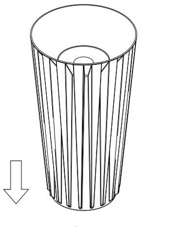
**A. Stellen Sie den freistehenden Waschtisch in die gewünschte Position und schließen Sie das ausziehbare Rohr an den Abfluss am Boden an.**
